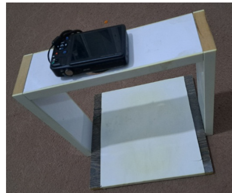
شکل ۷ نمایی از دوربین دیجیتال و وسیله مناسب اخذ تصاویر دست
