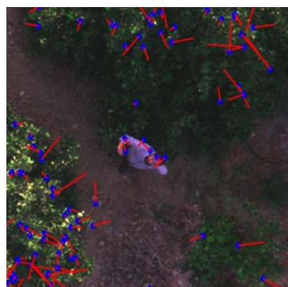
شکل ۸ نمایش بردار خطای نقاط از تصویر هم مرجع سازی شده با ۲۰ برابر بزرگنمایی. نقاط با مربع آبی و جهت بردارها با خط قرمز ترسیم شده است
